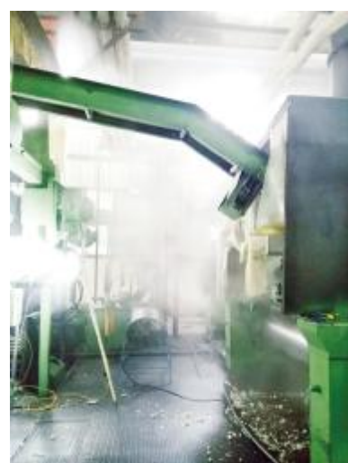
伟力塑胶压延车间废气收集不完善。
